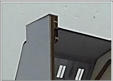
Fixer les bords verticaux à la colle à bois en veillant à l'équerrage. Il n'y a qu'une seule possibilité de montage grace aux détrompeurs.
