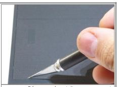
Découper les toitures en avant marqué plus profondément au cutter la rainure centrale. Ici sera faite la pliure du faîtage.
