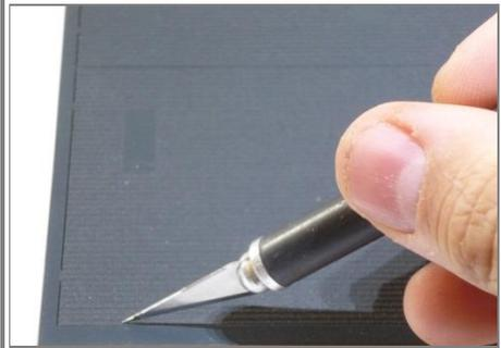
**9** Découper les toitures en ayant marqué plus profondément au cutter la rainure centrale. Ici sera faite la pliure du faitage.
