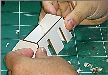
**2** Découper les différentes pièces au cutter en incisant des 2 côtés de la planche si besoin. Fixer les bords verticaux à la colle à bois en veillant à l'équerrage ainsi que les charpentes situées sur les ailes. Elles feront office de support de la toiture.
