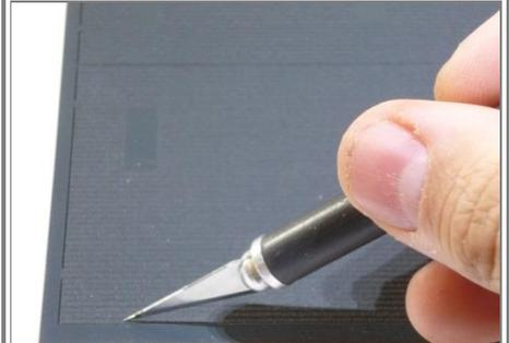
**9** Découper les toitures en ayant marqué plus profondément au cutter la rainure centrale. Ici sera faite la pliure du faîtage.
