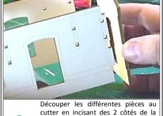
planche si besoin. Fixer les bords verticaux à la colle à bois en veillant à l'équerrage. Il n'y a qu'une seule possibilité de montage grace aux détrompeurs.
