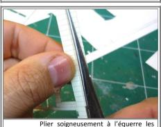
Plier soigneusement à l'équerre les parements d'angles (angles de murs, jambages de portes et fenêtres...) à l'aide d'une pince brucelles ou d'un réglet.
