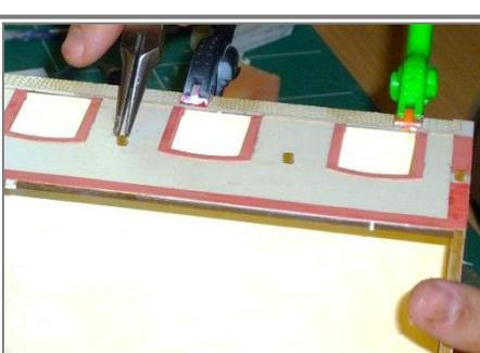
**8** Après peinture dans le même coloris que les parements, mettre en place les supports de charpente en les maintenant le temps de la prise. Faire de même avec les bois de charpente et portes.
