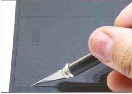
**7** Découper les toitures en ayant marqué plus profondément au cutter la rainure centrale. Ici sera faite la pliure du faîtage.
