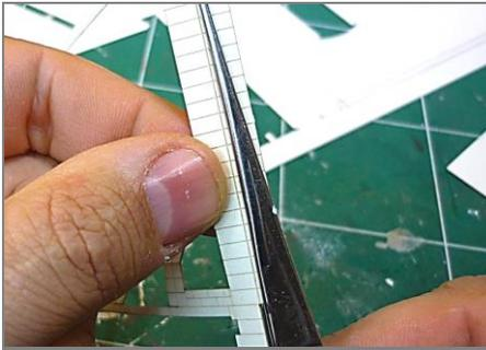
**5** Plier soigneusement à l'équerre les parements d'angles (angles de murs, jambages de portes et fenêtres...) à l'aide d'une pince brucelles ou d'un réglelet.
