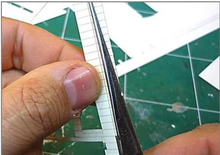
**5** Plier soigneusement à l'équerre les parements d'angles (angles de murs, jambages de portes et fenêtres...) à l'aide d'une pince brucelles ou d'un réglet.
