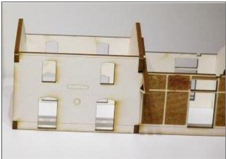
**1** Découper les différentes pièces au cutter en incisant des 2 côtés de la planche si besoin. Fixer les bords verticaux à la colle à bois en veillant à l'équerrage. Il n'y a qu'une seule possibilité de montage grâce aux détrompeurs.
