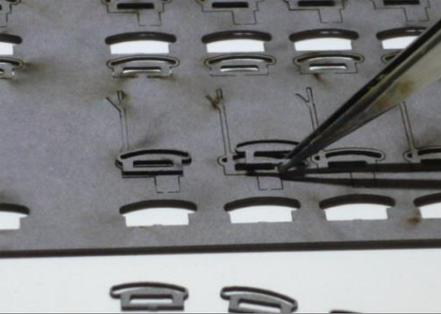
**4** Pour monter un levier d'aiguille, après mise en peinture si vous le souhaitez : détacher les 3 éléments qui composent un levier (le central avec le manche + 2 extrémités) et coller le tout.
