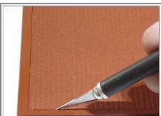
Découper les toitures en ayant marqué plus profondément au cutter la rainure centrale. Ici sera faite la pliure du faîtage.
