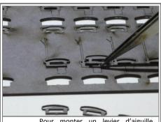
Pour monter un levier d'aiguille, après mise en peinture si vous le souhaitez : détacher les 3 éléments qui composent un levier (le central avec le manche + 2 extrémités) et coller le tout.
