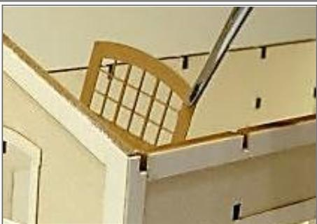
**7** Découper aux dimensions la feuille de plastique transparent des vitrages et appliquer sur la face intérieure (non gravée) des huisseries avec la colle à bois. Coller les ensembles obtenus depuis l'intérieur du bâtiment.
