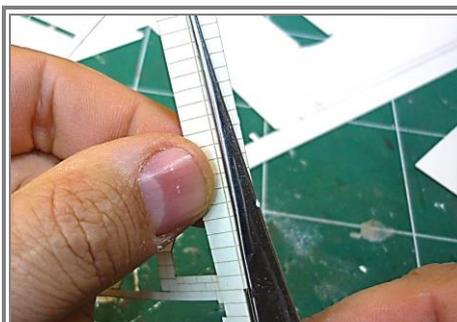
**5** Plier soigneusement à l'équerre les parements d'angles (angles de murs, jambages de portes et fenêtres...) à l'aide d'une pince brucelles ou d'un règlet.
